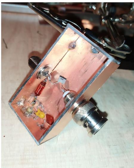
L'arrivée du 12 V est découplée à la masse par un bypass de 1 nF (non critique), un 100 nF et un 4,7  $\mu$ F.
