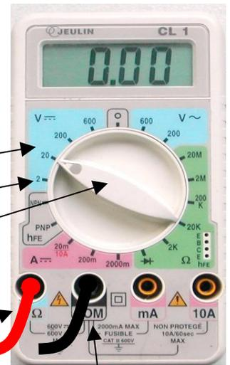
le courant qui sort du générateur doit entrer dans le voltmètre par la borne V.
